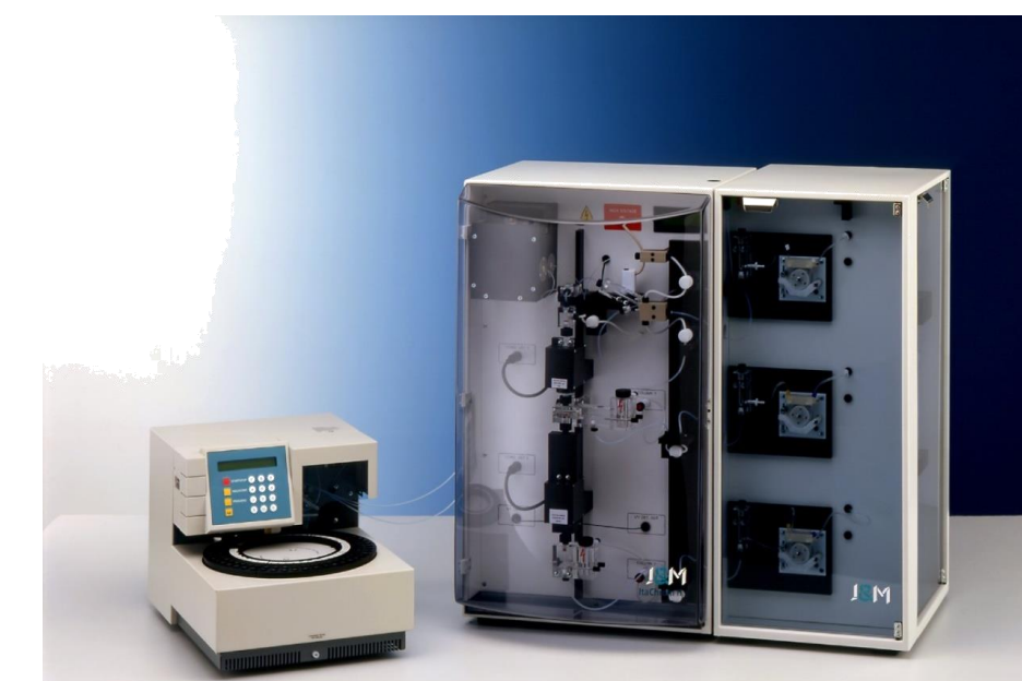
Automatizovaný dvojkoľonový elektroforetický analyzátor vyvinutý na katedre (2001).
